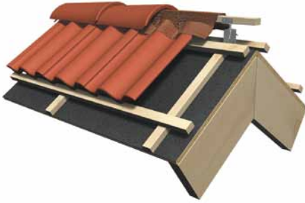
Bilde 7. Det er viktig at møne og valmtetningsrullen ikke ligger mot sidene på mønekammen, kun på toppen. Da får du best utlufting.
