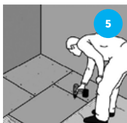
Skru platene direkte i underlaget. Ingen forboring er nødvendig. Anvend AQUAPANEL® Maxiskrue SN25. 9 skruer pr plate. Skruavstand minst 15 mm fra kanten.
