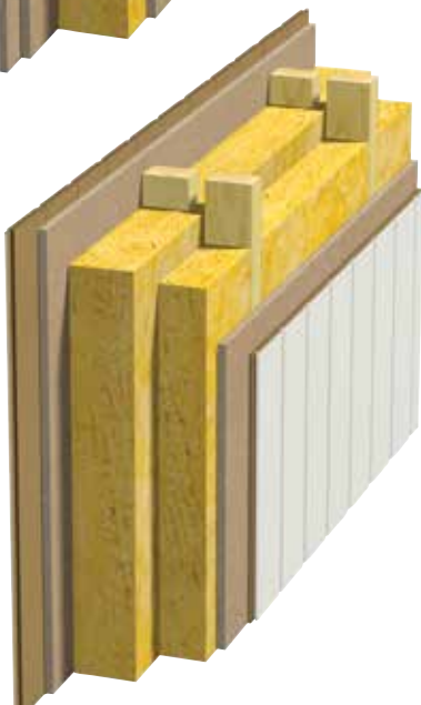
Fig. 4 Innvendig vegg. Dobbel heltre stender. To platelag.
