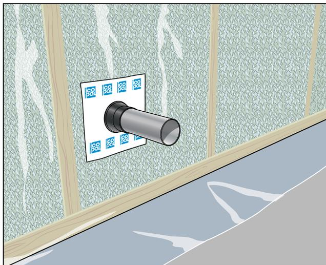
**Icopal Rørmansjett** består av en selvklebende krave med akryllim og en flens av gummi. Mansjetten brukes til tetting av rørgjennomføringen på vindspærre- eller dampspærresjikt. Ved bruk av rørmansjett utvendig må mansjetten tildekkes med en gang den er klebet på vindspærren.
