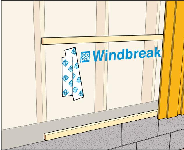
**ICopal Universaltape FT** gir god lufttetting ved forsegling av rifter i dampspærren eller vindspærren. Klipp til tapebitene så de dekker skadens lengde. Tapebitene skal presses tett til underlaget og overlappe hverandre.
