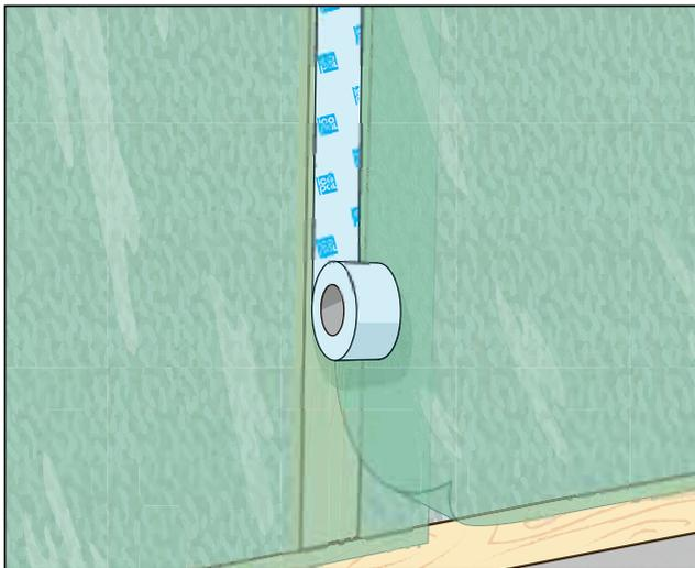
**ICopal Universaltape FT** brukes til forsegling av skjøter og overganger i vindspærre- eller dampspærresjikt.
