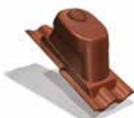
Kombihette plast Tilkobling til ventilasjon er Ø160. Rør for avløper Ø110. Kan brukes ved takvinkel mellom 20-45°. Ventilasjonshetten leveres komplett med underbeslag. Kun Palema.
