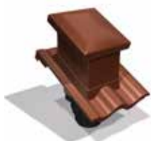
Ventilasjonshette plast Tilkobling til ventilasjon er Ø160 mm. Kan brukes ved takvinkel 15-45°. Leveres komplett med underbeslag og multiadapter.
