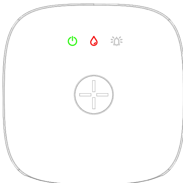
Ventilen er stengt
