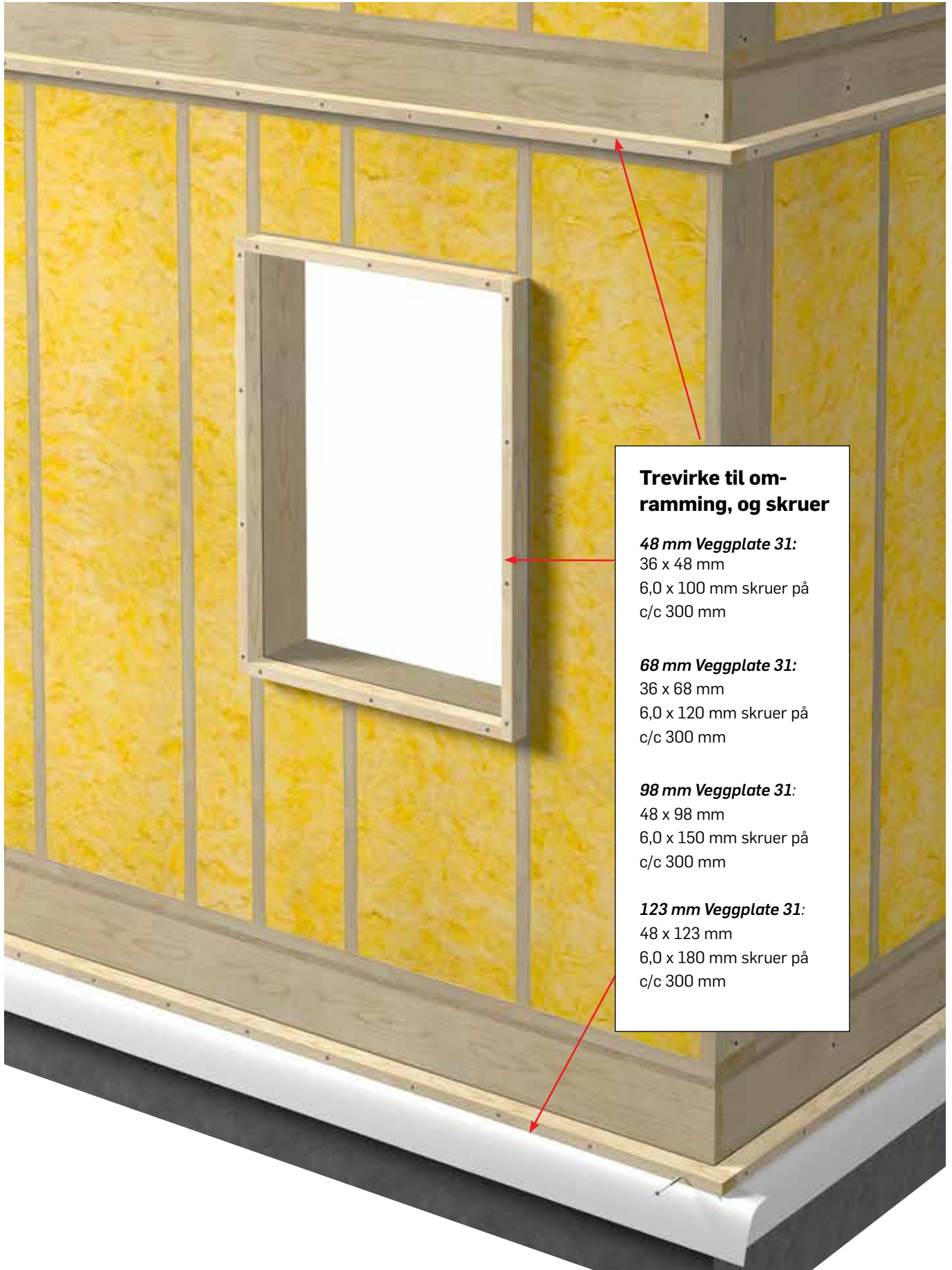
Omramming ferdig montert
