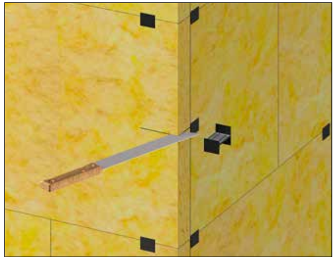
Ekstra veggplatebraketter slisses inn i hjørnene for bygg med mer enn to etasjer.
