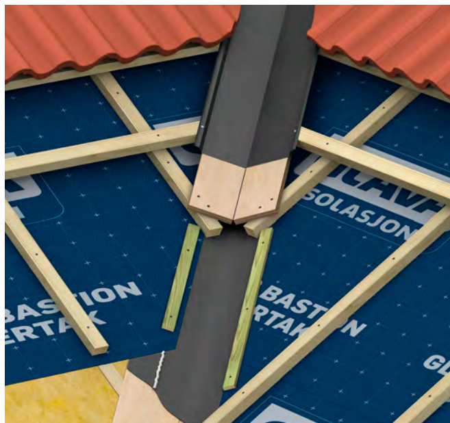
Fig. 19 Prinsipp for kilrenne med kilrennemembran
