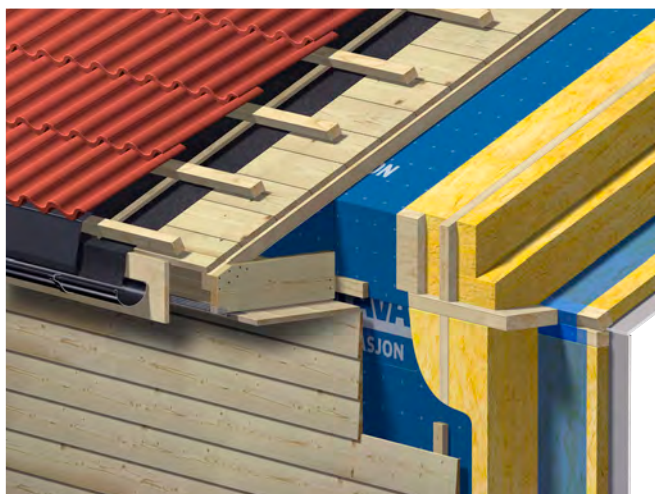
Fig. 33 Bastion vindsperre i takkonstruksjon med tradisjonelt lufteskikt
