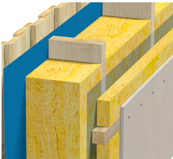
Fig.40 Yttervegg med inntrukket dampsperre
