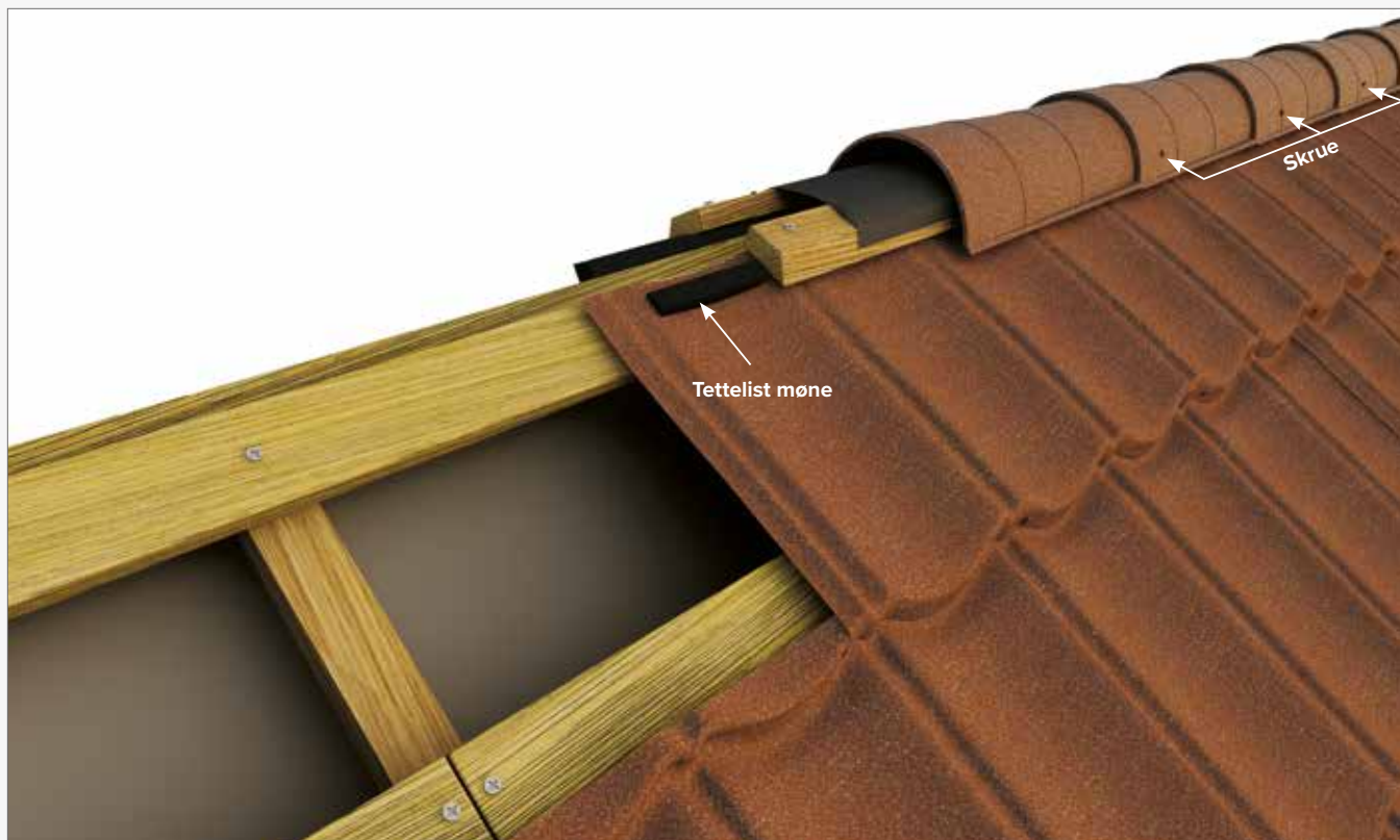
ALTERNATIV 2: Møne – Montering med tetteliste møne og møne buet.
