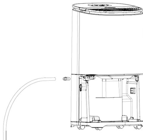
**Steg 2:** Fjern vinkeladapteren fra vanntanklokket og skyv den inn på tuten. Tuten er der vann renner ut av avfukteren og er plassert på venstre side.
