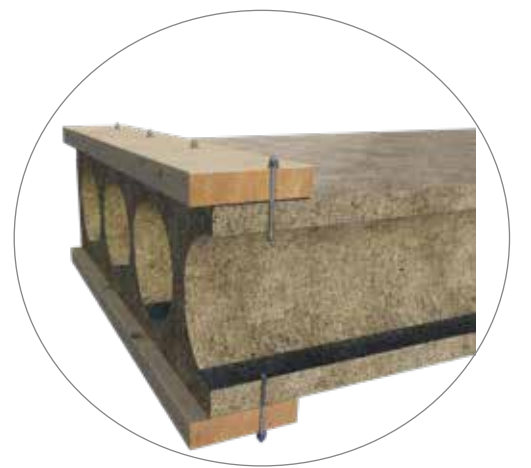
Y07-222 Tresvill til hulldekke av betong
