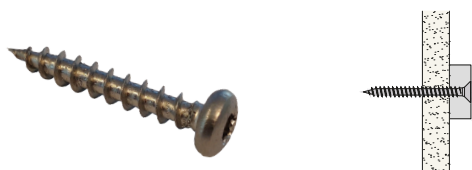
Direkte oppheng med 5 mm skrue i Habito-plate.
